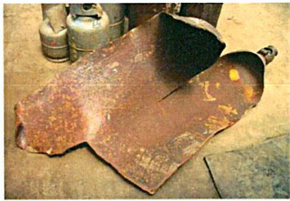
約 8 年間放置された酸素破裂容器の全景
