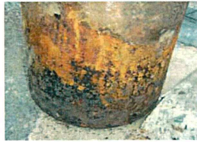
放置による酸素容器の腐食
